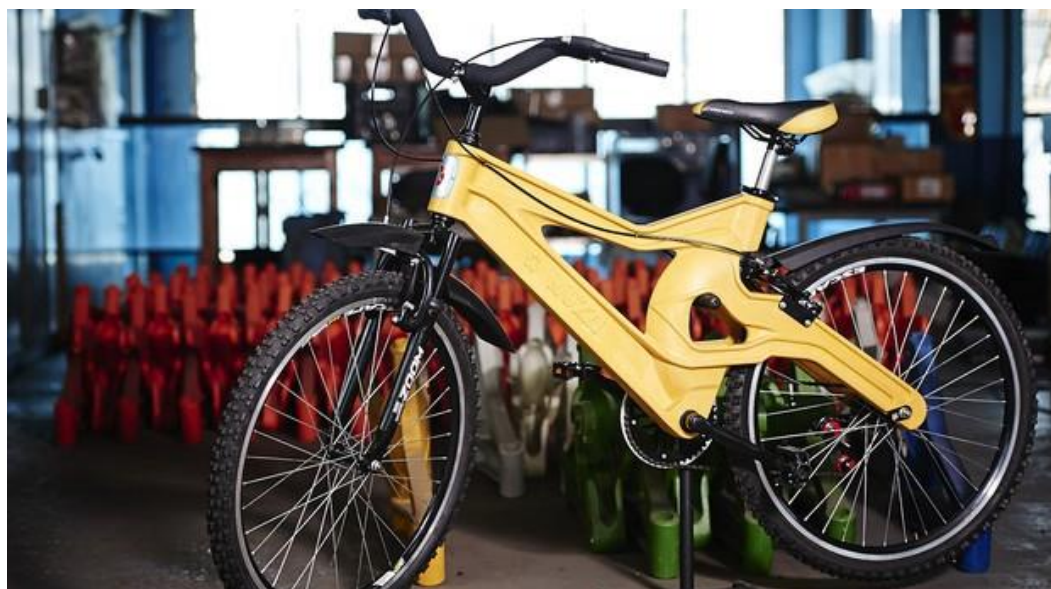
Muzzicycles: uso do plástico reciclado na fabricação dos quadros das bicicletas.
